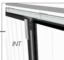
Côté refoulement Joint à lèvres ou joint brosse selon dimensions écoinçons
