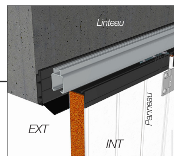
Vue intérieure Joint à lèvres (linteau)
