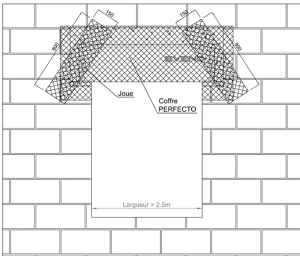
Figure 25 - Mise en place de l'armature d'enduit pour largeur tableau > 2,5 m
