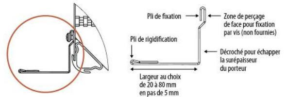
NB : pli de fixation à positionner au-dessus du porteur bas
