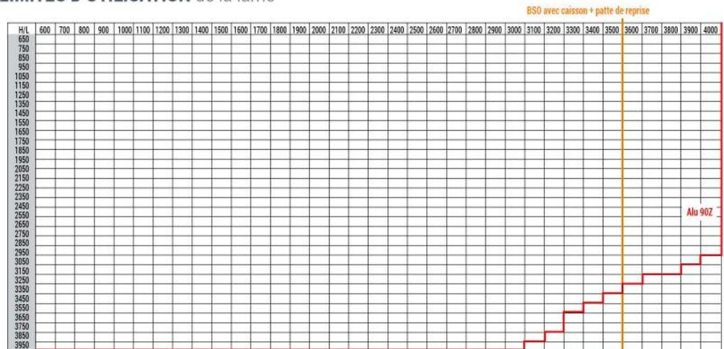
\* Pour les largeurs supérieures à 3600 mm, le BSO a des particularités de pose. Le produit n'est plus autoporté, il est nécessaire de prévoir une reprise de fixation au linteau en partie centrale. Si LDC < 3600, pas de caisson - Si LDC > 3600 ou surface > à 9 m<sup>2</sup>, et caisson pattes de reprise fournis en standard.
